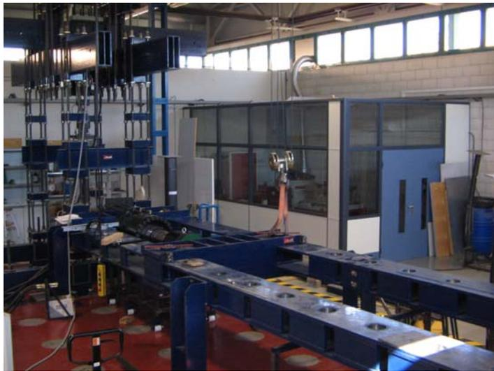
Fig. 4-9 Pórtico horizontal de 5000kN y 4.5m
