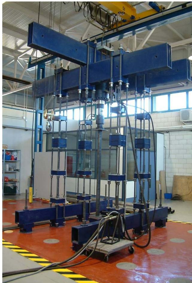
Fig. 4-8 Pórtico vertical de 2000kN y 2.5m
