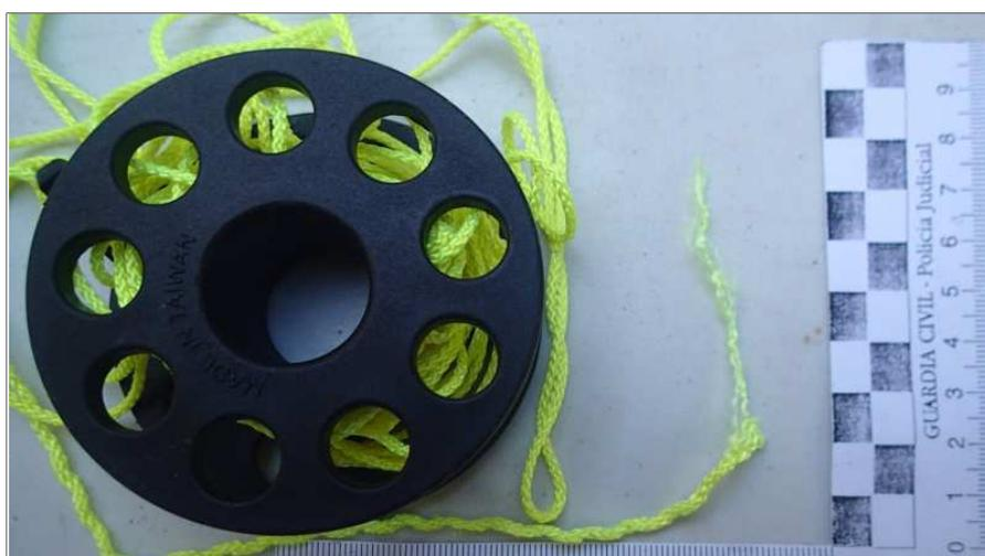
**Figura 60.** Carrete de cuerda causante del atrapamiento de un buceador.
