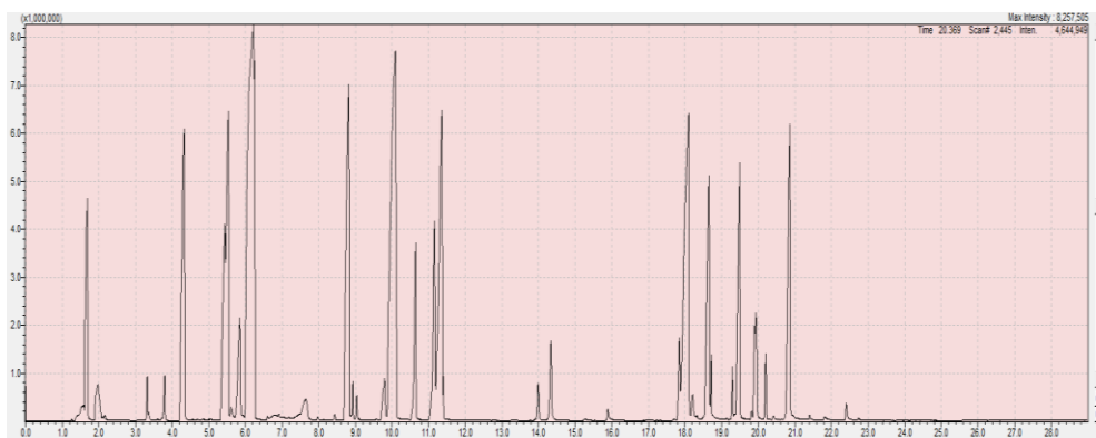
Figura 103. Cromatograma de solución patrón de aroma de fresa DL110560 diluido 1/10 en metanol.
