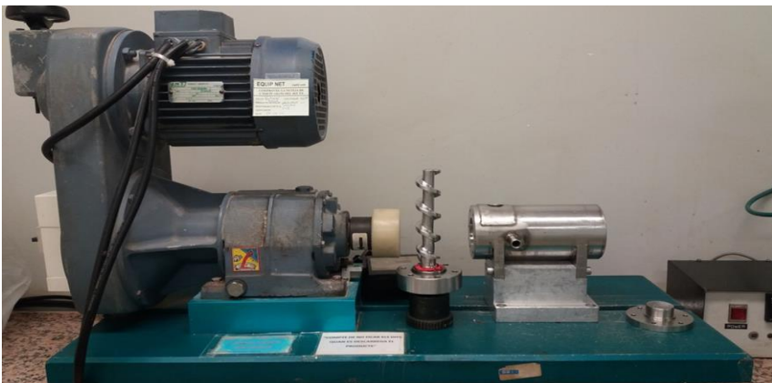
Figura 4. Vista frontal extrusor axial con sus diferentes partes desmontadas: plataforma fija, tornillo móvil, cuerpo del extrusor y tamiz de luz de malla determinada.
