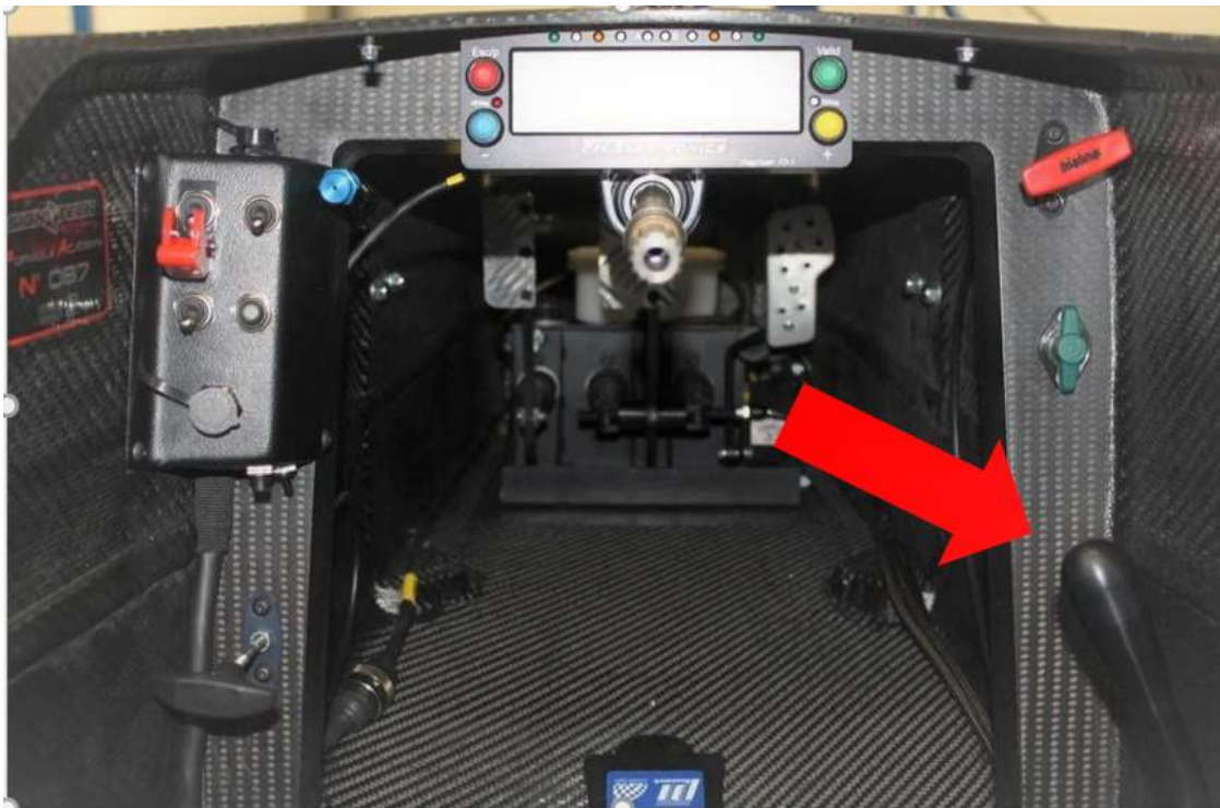
Figura 32. Detalle de la palanca de cambio del interior de un Formula Renault 1.6 (Fuente Renault Sport Spain)
