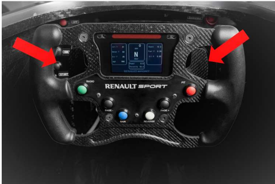
Figura 33. Detalle de las palancas de cambio (levas) en el volante de un Formula Renault 2.0 (Fuente Renault Sport Spain)
