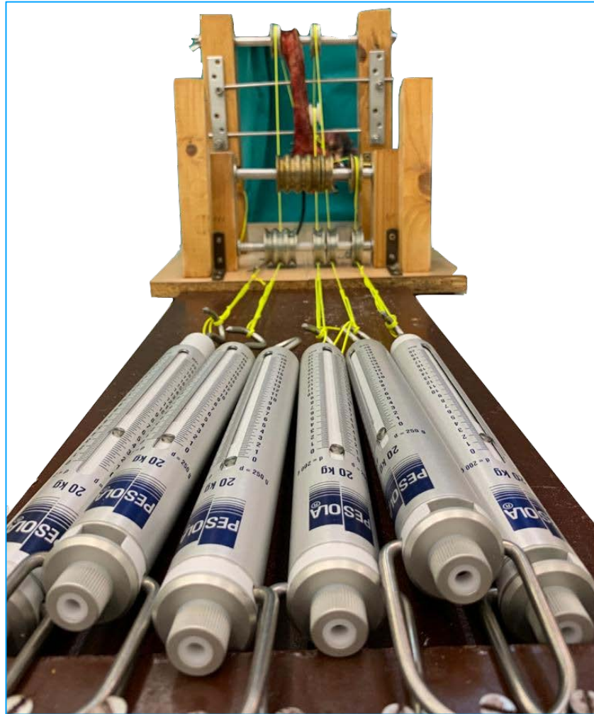
Figura 8. Detalle posterior de la mesa de experimentación donde pueden verse los dinamómetros que ejercen las fuerzas controladas sobre las cuerdas de tracción.
