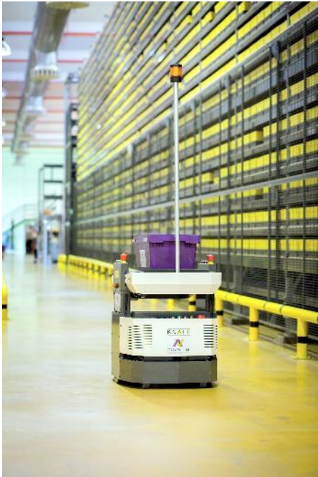
Ilustración 16. Detalle del sistema de transporte autoguiado
