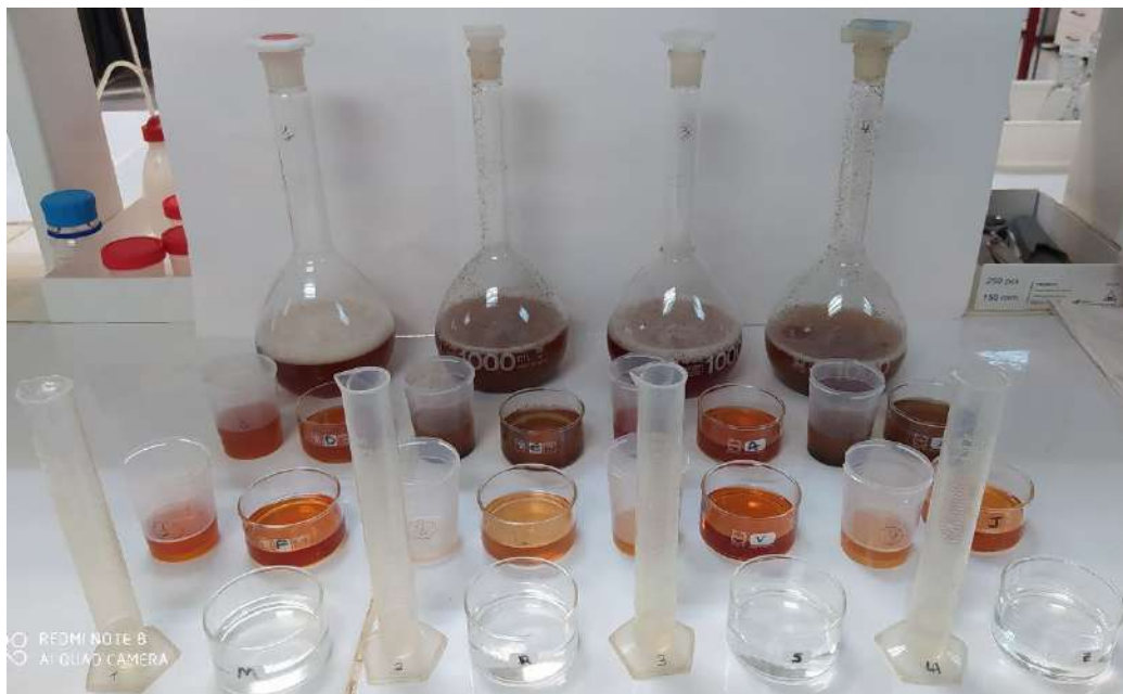
Figura 57. Ensayo para la determinación de taninos de acuerdo con la ISO 14088:2012. Fracción líquida y sólida de la extracción con aditivo 2 (izq); Fracción líquida y sólida de la extracción con aditivo 1 (der)
