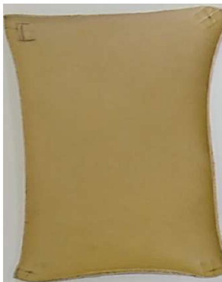
Figura 29. Piel curtida con polvo de corteza de pino
