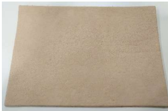
Figura 36. Piel curtida con extractos vegetales de mimosa y quebracho
