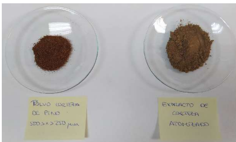
Figura 62. Materia prima empleada en la extracción de taninos (izq) y el extracto CP ATO (der)
