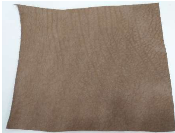
Figura 39. Aspecto de la piel curtida con polvo de corteza de pino
