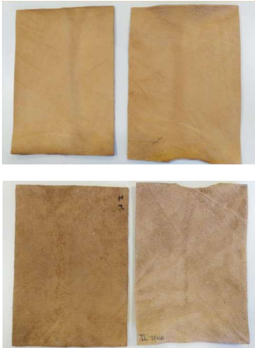
Figura 34. Piel curtida con polvo de corteza y re-curtida con polvo de corteza de pino (flor, izda superior; carne, izda inferior); Piel curtida con polvo de corteza y re-curtida con polvo de tara (flor, der. Superior; carne, der. Inferior)
