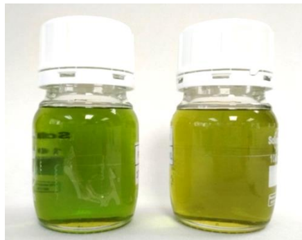
Figura 5.4-1. Vials descongelats després de 6 mesos conservats a -20\text{ }^{\circ}\text{C} . El vial de l'esquerra s'havia congelat a -20\text{ }^{\circ}\text{C} (C). El vial de la dreta s'havia congelat amb nitrogen líquid (F).
