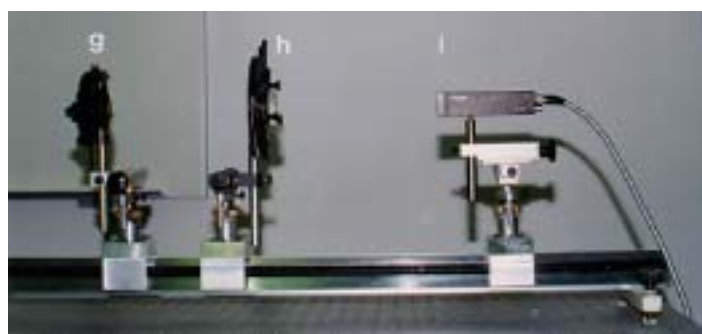
Figura 3.16. Detall del dispositiu experimental (II): pla de Fourier P_2 (g), la lent L_2 (h) i el pla de correlació (i) del correlador convergent experimental. En (g) es situa el filtre adaptat a l'objecte a reconèixer. El pla del sensor CCD de la càmera en b/n coincideix amb el pla de correlació.
