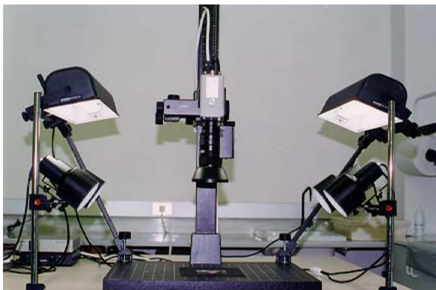
Figura 3.7. Sistema de captació per a l'obtenció de la descomposició multicanal RGB. Càmera en color de 3 CCD Sony DXC-930 P. Il·luminació amb llum fluorescent de 5000 K de temperatura de color.
