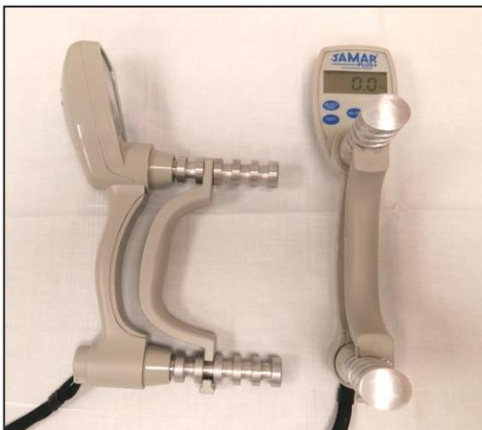
**Figura 6.** Dinamómetro Digital Jamar® Plus +.
