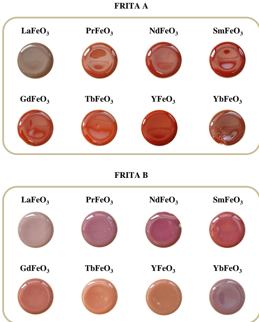
Figura 4.18. Imágenes de la aplicación de pigmentos sintetizados en esmaltes.
