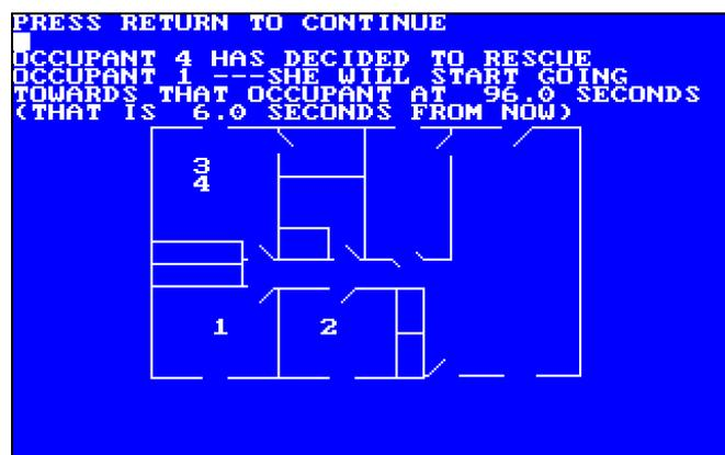
**Figura 2.27** Simulación del desarrollo de un incendio y evacuación mediante EXITT
