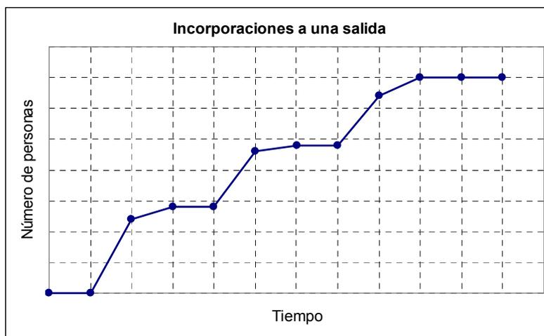
**Figura 3.26** Función de carga de una salida
