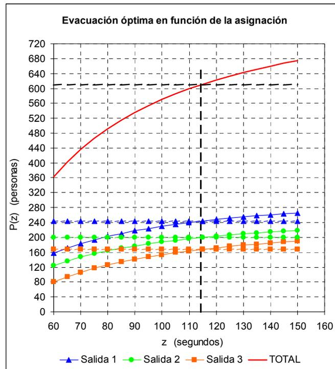
**Figura 4.18** Optimización de la evacuación intervalo estacionario
