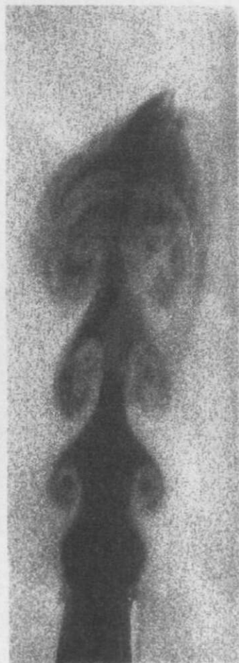
Desembocadura de un hilo de líquido bajo la superficie de aguas en calma en dos estadios sucesivos.
