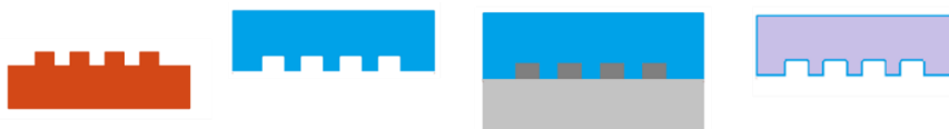
Figura 19 - De izquierda a derecha se observa el esquema de a) impresión 3D del negativo de los canales. b) Copiado en silicona de estos canales. c) Crecimiento de los canales de Níquel sobre el disco de acero. d) Pieza inyectada sobre el disco de níquel con canales.
