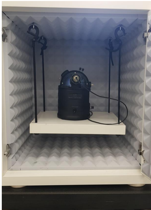
Figura 30 - AFM usado con el sistema de mesa anti vibratoria y espuma para la cancelación de vibraciones externas.
