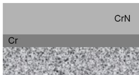
Figura 17 - Esquema de la estructura de recubrimiento de CrN
