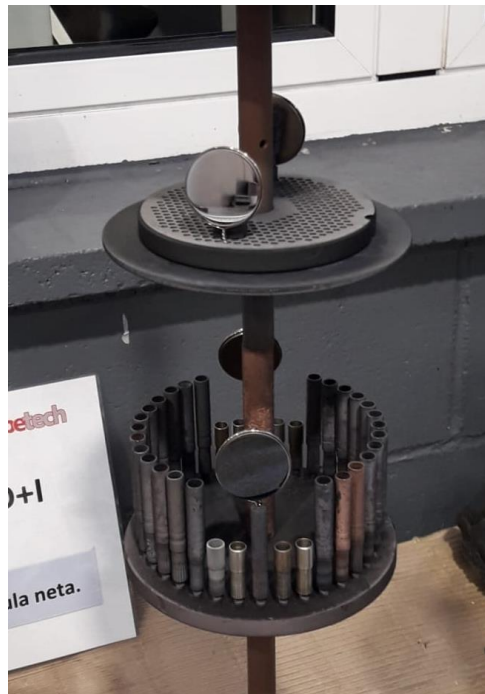
Figura 16 - Muestras preparadas para entrar en el reactor PVD. Arriba, muestras a 2 rotaciones. Abajo, muestras a 3 rotaciones.
