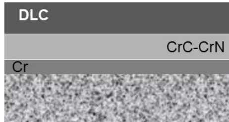
Figura 18 - Esquema de la estructura de recubrimiento de DLC
