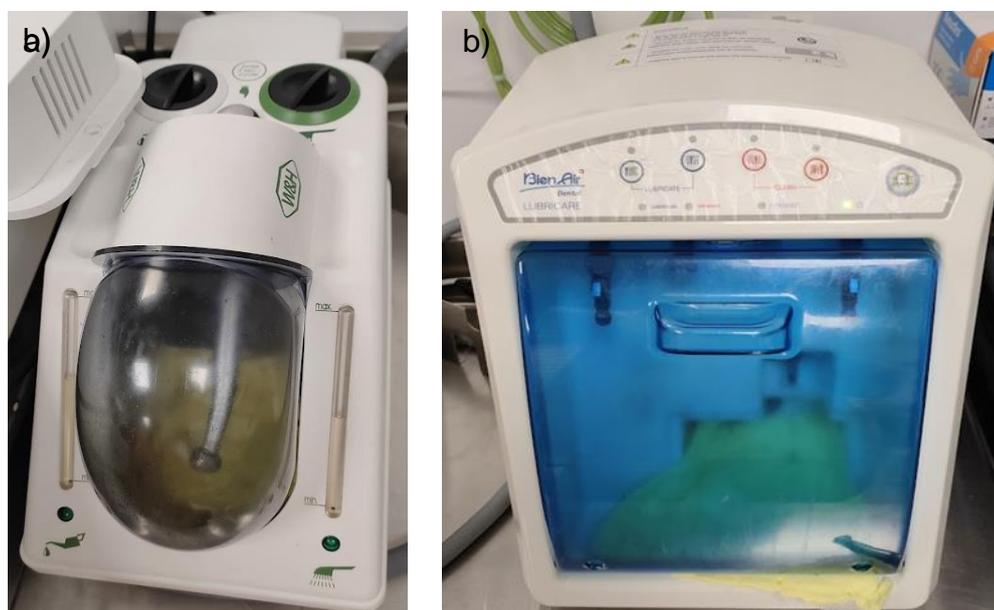
Figura 6: máquinas utilizadas para la desinfección, limpieza y lubricado del instrumental rotatorio
