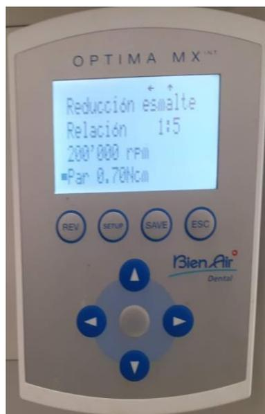
Figura 5: parámetros de funcionamiento del Micromotor Optima MX (Bien-Air, Bienne, Suiza).
