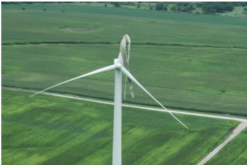
Figura 1. Aerogenerador impactado por un rayo cerca de Brieke (Alemania), en julio de 2009. (Adaptado de Better Plan, 2023).
