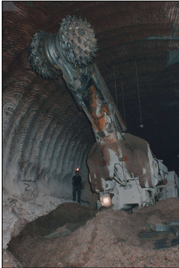
Figura 4.10. Minador emprat per arrancar el mineral en les mines de potassa que utilitzen el mètode anomenat de cambres i pilars.
