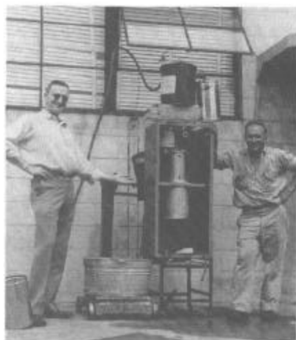
Fig. A1-1. Científics del Massachussets Institute of Technology (EUA) calibrant un pluviògraf Hudson-Jardí -basat en l'instrument desenvolupat anys abans a Barcelona- l'any 1948 per comparar les mesures de radar amb la intensitat de pluja (Atlas, 1990).
