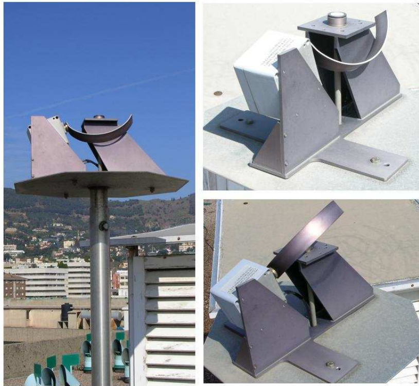
Figura 3.1: Fotografies del capçal de l'espectroradiòmetre Bentham 300 amb banda para-sol automàtica per a realitzar la mesura d'irradiància difusa (imatge inferior de la dreta) instal·lat al terrat de la Facultat de Física.
