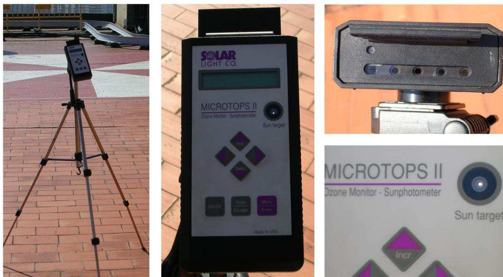
Figura 3.6: Fotografies del fotòmetre Microtops al terrat de la Facultat de Física de la Universitat de Barcelona.
