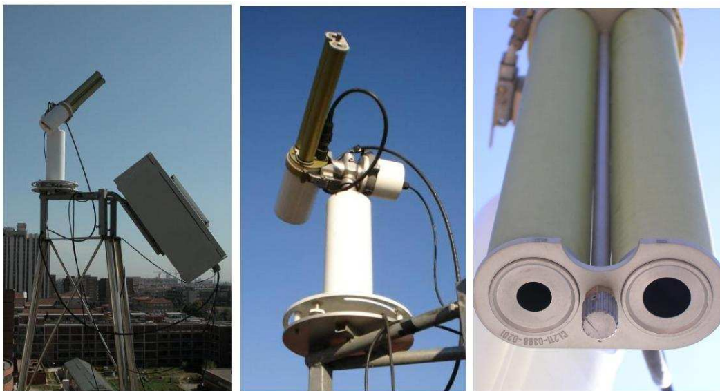
Figura 3.7: Fotografies del fotòmetre CIMEL instal·lat al terrat de la Facultat de Física.
