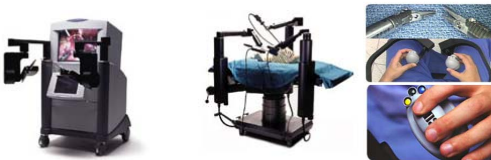
Figura 4.36. Sistema Zeus. 5GDL, 3 brazos robot, cámara 3D, instrumentos de 4mm. A la derecha los efectores terminales y el sistema de controladores Micro-Wrist .
