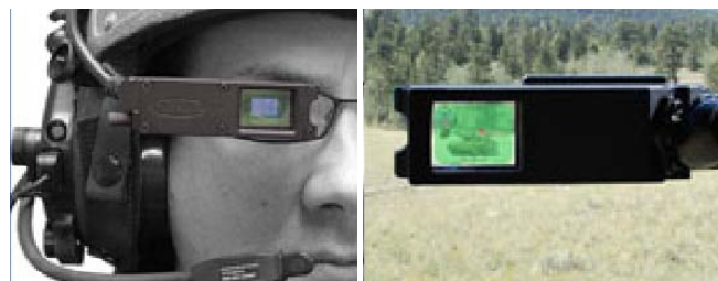
Figura 2.5 HMD con visualizador transparente.
