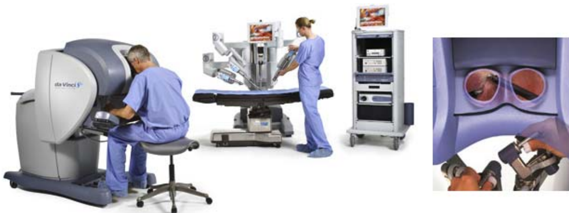
Figura 4.35. DaVinci Surgical System. 6GDL, 3-4 brazos robot, cámara 3D, instrumentos de 8mm.
