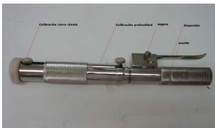
Figura 1. Esquema del aparato “ Spring loaded biopsy ”.
