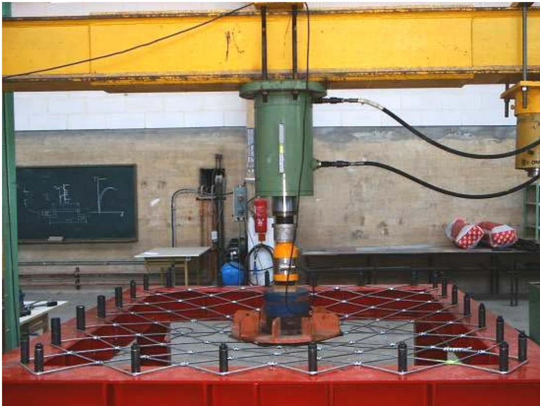
Figura 79.- Ensayo de carga puntual sobre red de cables.
