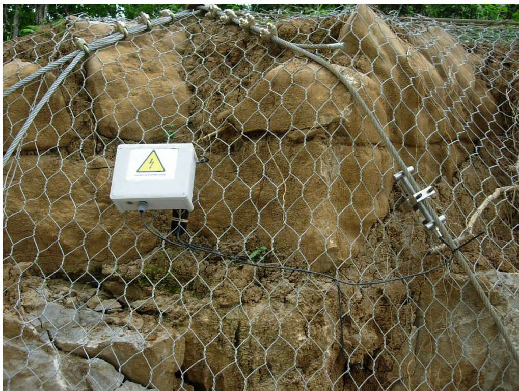
Figura 36.- Segunda zona de medición. Sensor en el cable de 16 mm. Equis de la zona vertical.
