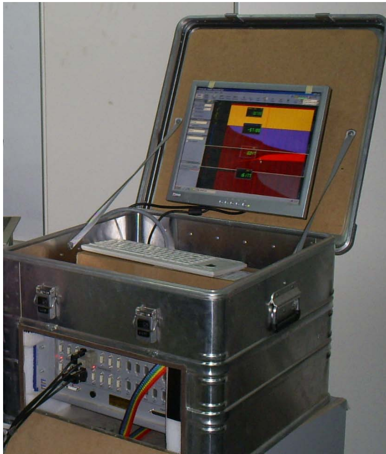
Figura 18.- Equipo de adquisición de datos (Dewetron ).
