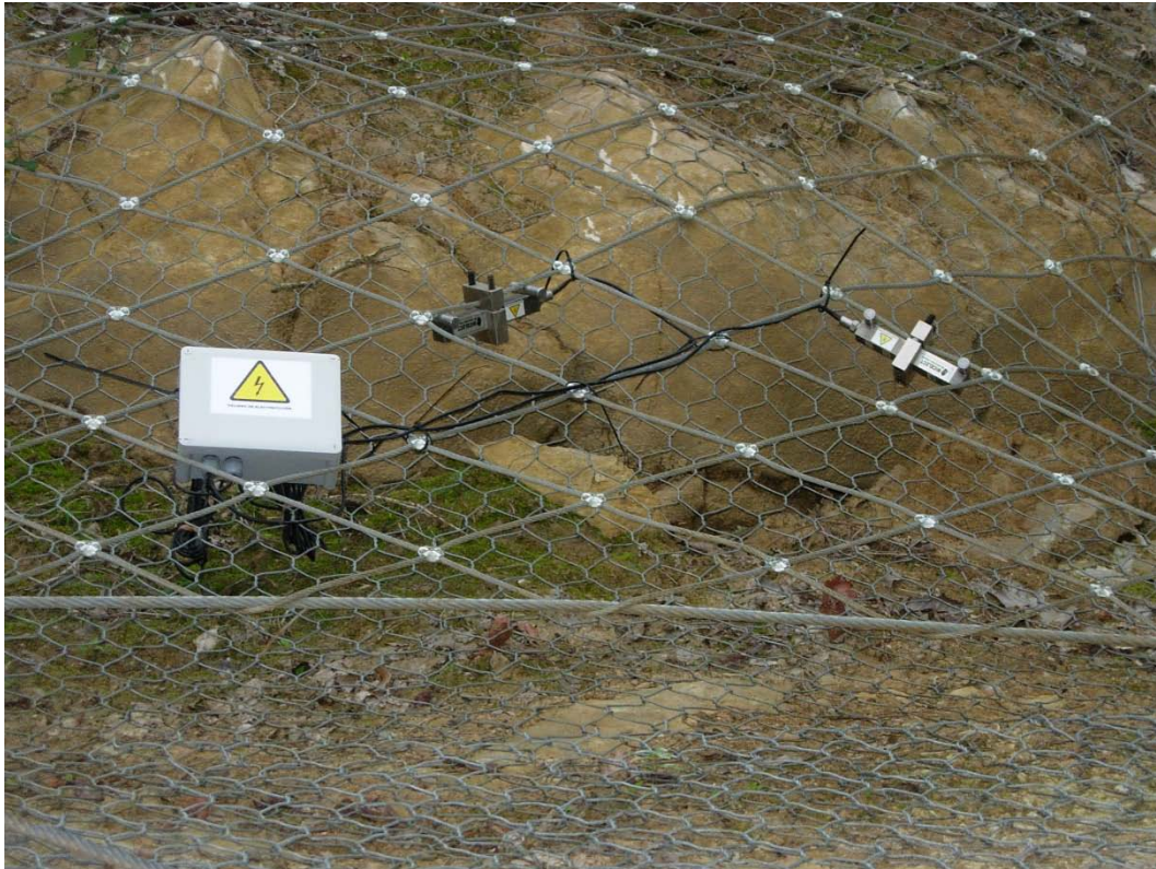
Figura 35.- Primera zona de medición. Dos sensores en red de cables de 8 mm. Diagonales de un paño de la zona inclinada.
