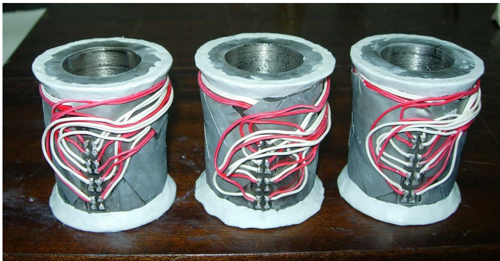
Figura 33.- Células de carga sin capuchón de protección. Vista de las conexiones del Puente de Wheatstone.
