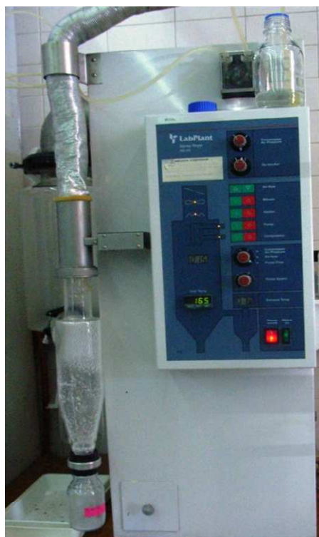
Figura 12. Vista general del atomizador (SD-05, Lab Plant, UK) utilizado para las pruebas de formulación de B. subtilis CPA-8 a escala de laboratorio.
