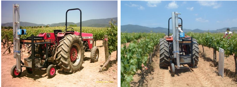
Figura 6.9. Montaje del LIDAR en los ensayos de Torre Marimón (Caldes de Montbui)
