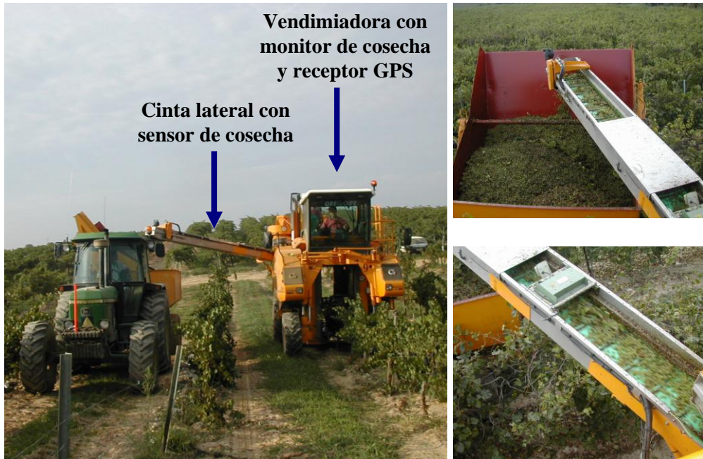
Figura 2.5. Conjunto vendimiadora y tractor+remolque (izquierda) y detalles de la ubicación del sensor de cosecha en la cinta lateral de descarga (derecha)
