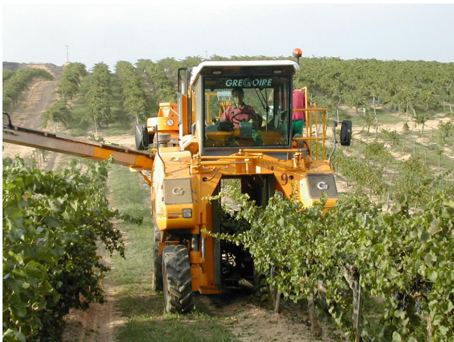
Figura 2.3. Vendimiadora Gregoire G-140 SW utilizada en los ensayos de recolección
