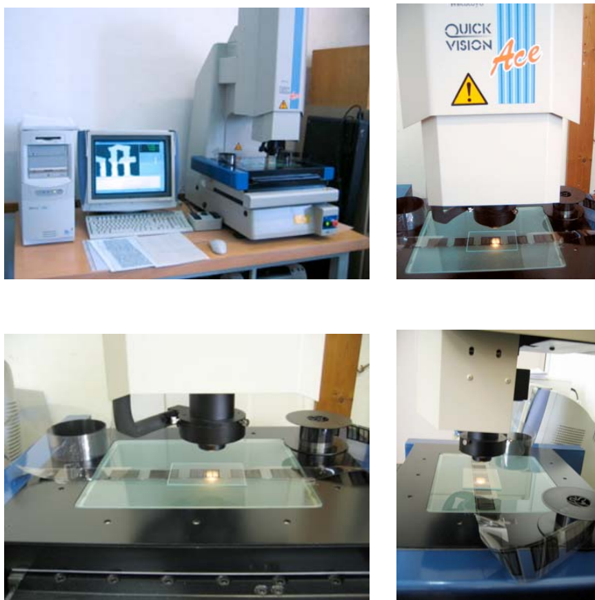
Fig. 115 Imágenes del aparato de medición Quick Vision durante el escáner del microfilm de la B42.
