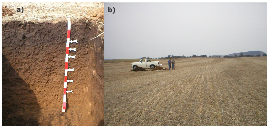
Figura I.3. Vista de un perfil típico de un suelo Serie Mar del Plata (INTA, 1979) (a) y de su paisaje (b) en el Partido de Balcarce (Provincia de Buenos Aires, Argentina) (fotografías G. Domínguez. com. personal, 2005).
