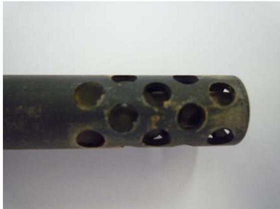
**Figura 4.5.27** Aspecto del sensor IQS 3 después de 7200 h de funcionamiento situado en la posición 4 del diseño experimental
