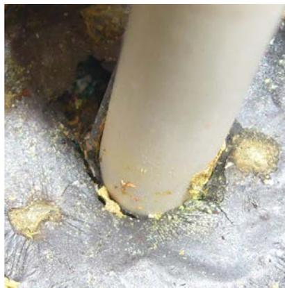
**Figura 4.4.10** Superficie del plomo-bismuto después de uno de los experimentos con níquel como impureza metálica.
