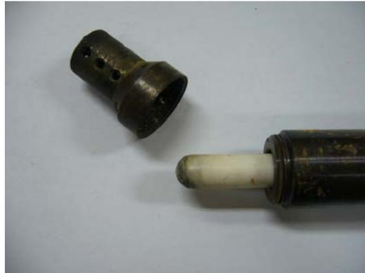
**Figura 4.5.17** Aspecto de la vaina de YSZ del sensor CIEMAT (In/In<sub>2</sub>O<sub>3</sub>)
