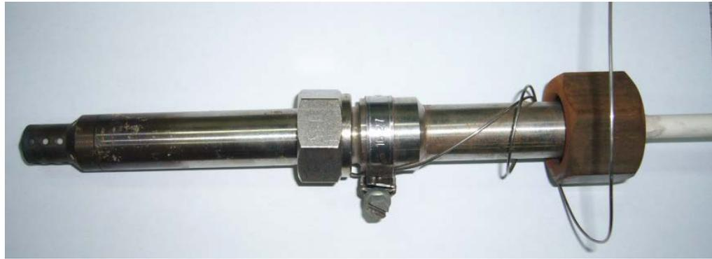
**Figura 4.5.16** Aspecto del sensor CIEMAT (In/In<sub>2</sub>O<sub>3</sub>) después de 4300h de funcionamiento
