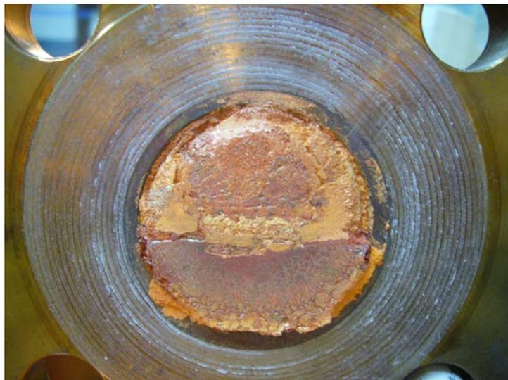
**Figura 4.5.13** Extremo del montaje correspondiente a la salida de gas después de 6800h de funcionamiento.
