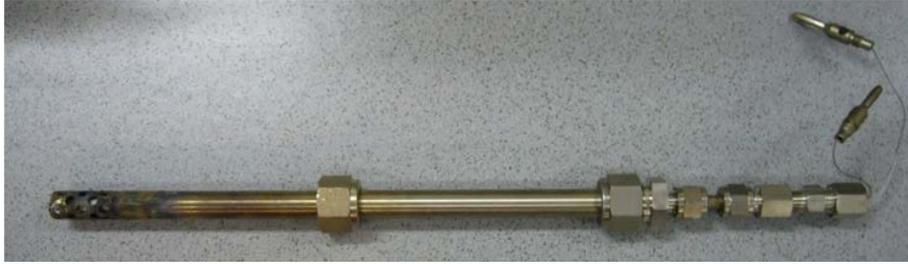
**Figura 4.5.14** Aspecto del sensor IQS 1 después de 6800h de funcionamiento
