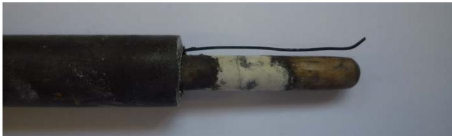
**Figura 4.5.28** Aspecto de la vaina de YSZ del sensor IQS 3 situado en la posición 4 del diseño experimental
