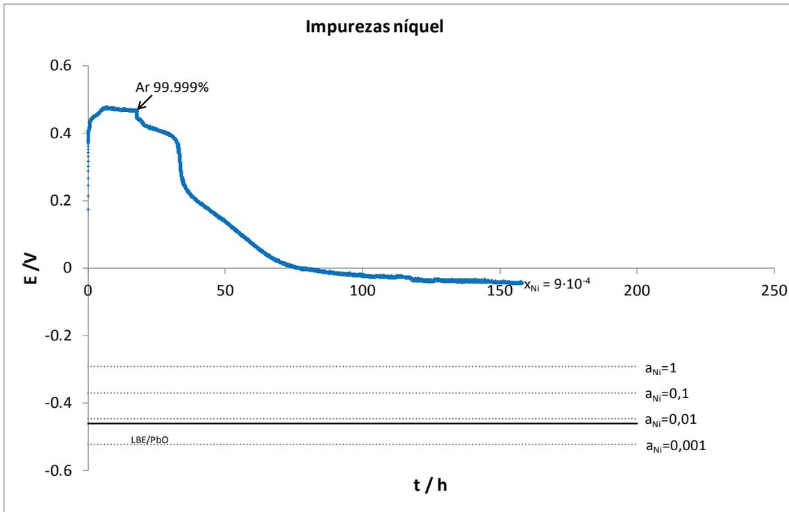
**Figura 4.4.9** Potencial del sensor con Ni como impureza metálica en el LBE y Ar+10%H<sub>2</sub> y Ar 99.999% como gases de cobertura
