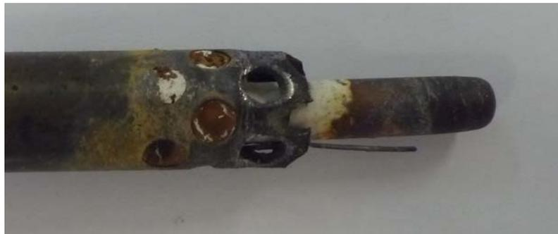
**Figura 4.5.30** Aspecto de la vaina de YSZ del sensor IQS 4 ( $\text{Bi/Bi}_2\text{O}_3$ ) situado en la posición 3 del diseño experimental
