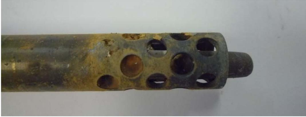
**Figura 4.5.29** Aspecto del sensor IQS 4 ( $\text{Bi/Bi}_2\text{O}_3$ ) después de 7200 h de funcionamiento situado en la posición 3 del diseño experimental
