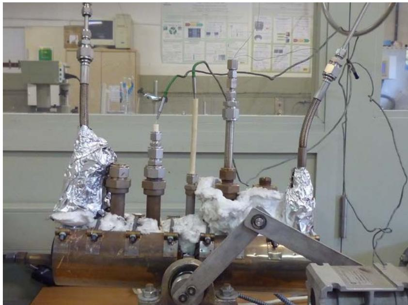
**Figura 4.5.23** Montaje experimental para el ensayo de sensores de oxígeno en condiciones dinámicas.
