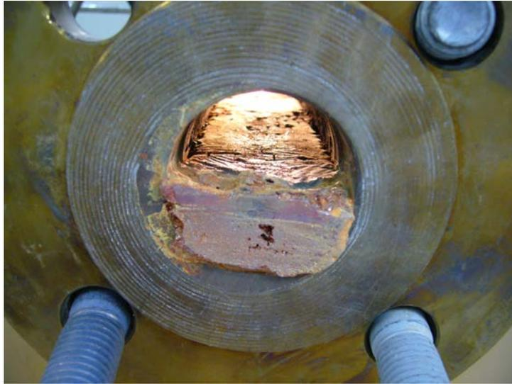
**Figura 4.5.12** Extremo del montaje correspondiente a la entrada de gas después de 6800h de funcionamiento
