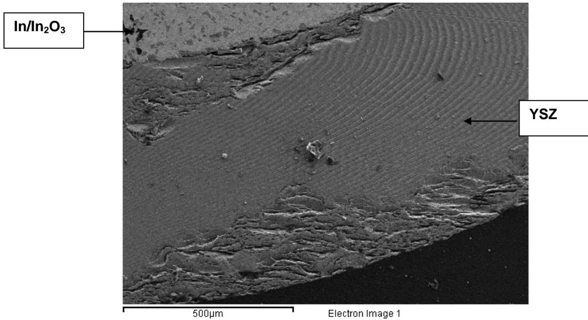
**Figura 4.5.32** Micrografía SEM de una sección transversal del sensor IQS 3 después de 7200h de funcionamiento.
