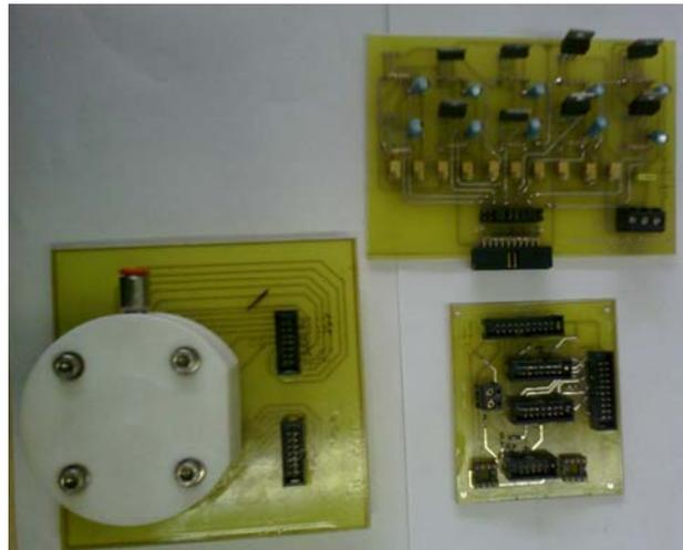
Figura 4.9.- Tarjetas de alimentación, adquisición y cámara de sensores.
