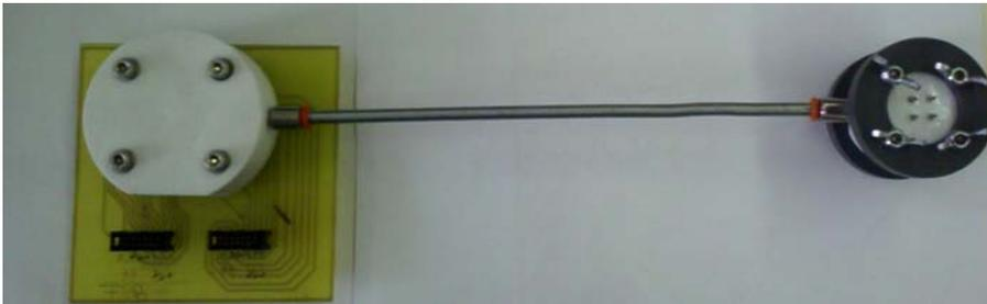
*Figura 4.13.- Conjunto de cámaras con su conexionado de acero inoxidable.*
