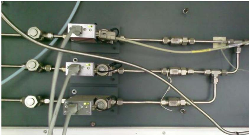
*Figura 4.15.- Fotografía del circuito de mass-flow empleados.*
