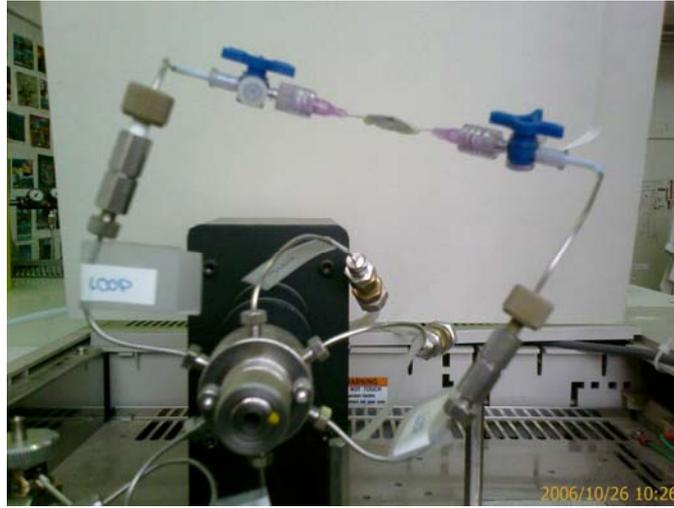
*Figura 4.20.- Concentrador colocado en el GC-MS.*
