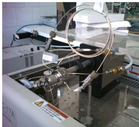
Figura 4.1b .- válvula de 6 vías
