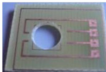
*Figura 3.33.- Soporte PCB del Concentrador.*
