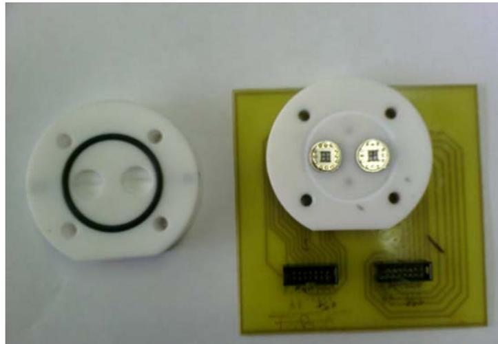
*Figura 5.9.- Cámara para el sistema Preconcentrador-Sensor.*
