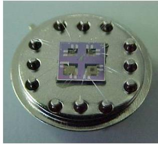
Figura 3.2.- Imagen de un chip con 4 membranas encapsuladas en un soporte TO8.
