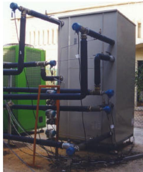
**Fig.5. 6** Fotografía de la instalación del equipo Yazaki WFC-10, en el banco de ensayos
