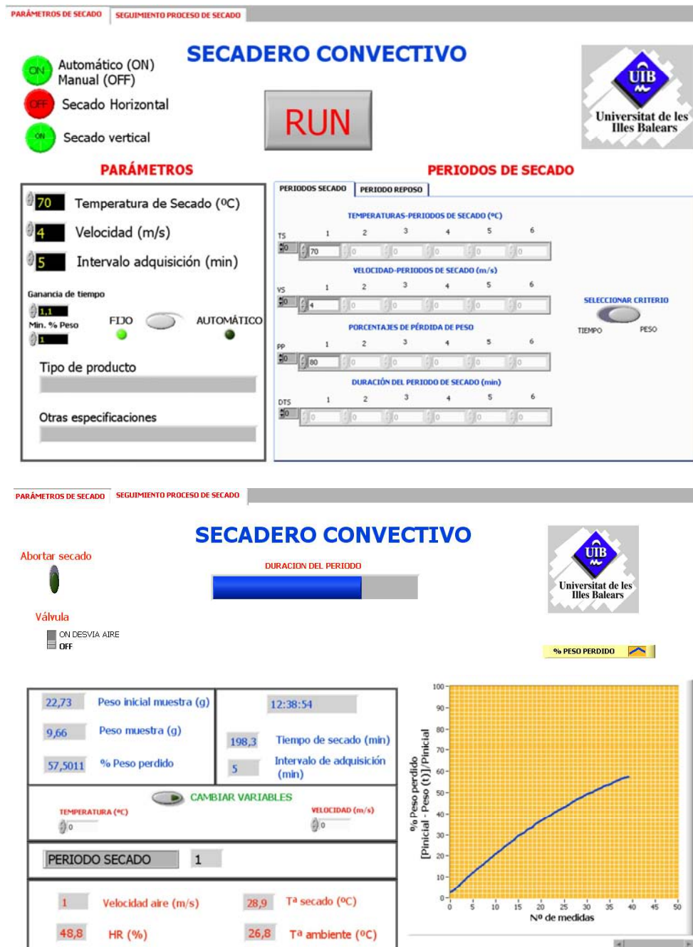
Figura 3.5. Aplicación informática en LabView para el control del secadero de vegetales a escala de laboratorio. Seguimiento del proceso de secado.
