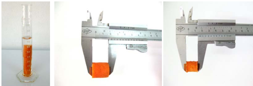
Figura 3.11. Medida del volumen y longitud de las muestras durante el secado por aire caliente de cilindros de zanahoria.
