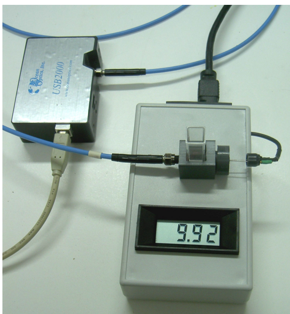
Figura 2.7. Sistema de detección espectrofotométrica constituido por un espectrofotómetro CCD (USB 2000, Ocean Optics), una fibra óptica conectándolo con la celda y un cabezal de diodos LED alimentado por una fuente de intensidad.
