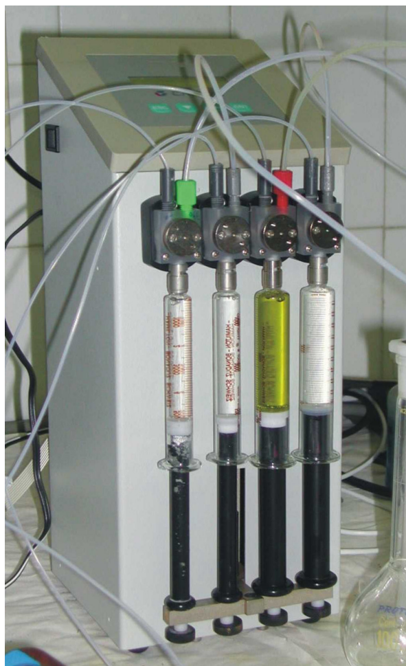
Figura 2.1. Módulo de multijeringa utilizado en un sistema MSFIA.
