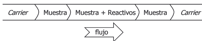
Figura 3.2. Esquema del tipo de inyección sándwich multiconmutada.
