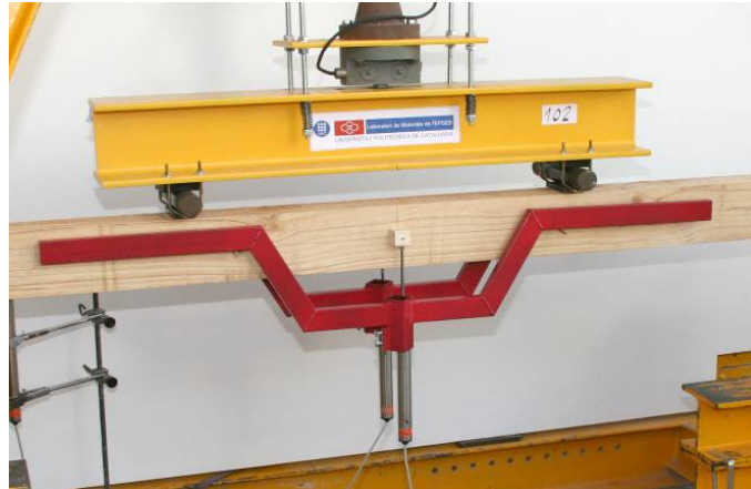
Figura 4.4 Perchas para la medición del módulo de elasticidad local
