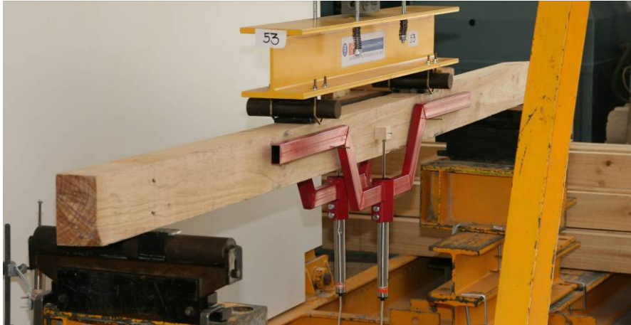
Figura 5.16. Disposición de las perchas soporte de los extensómetros para el ensayo del módulo de elasticidad local
