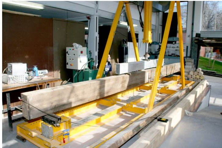
Figura 4.1 Pórtico de ensayos de la EPSEB
