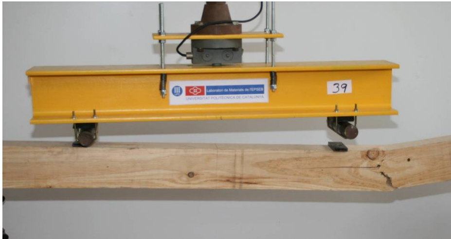
Figura 5.21 Rotura de la probeta fuera del tercio central
