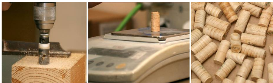
Figura 3.30. Probetas testigo, extracción, pesado y probetas
