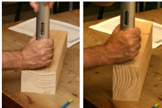
Figura 5.2. Penetración en dirección radial y tangencial
