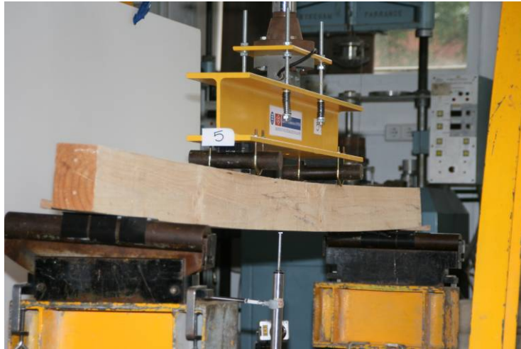
Figura 5.19 disposición de los distintos elementos en el ensayo del módulo de elasticidad global
