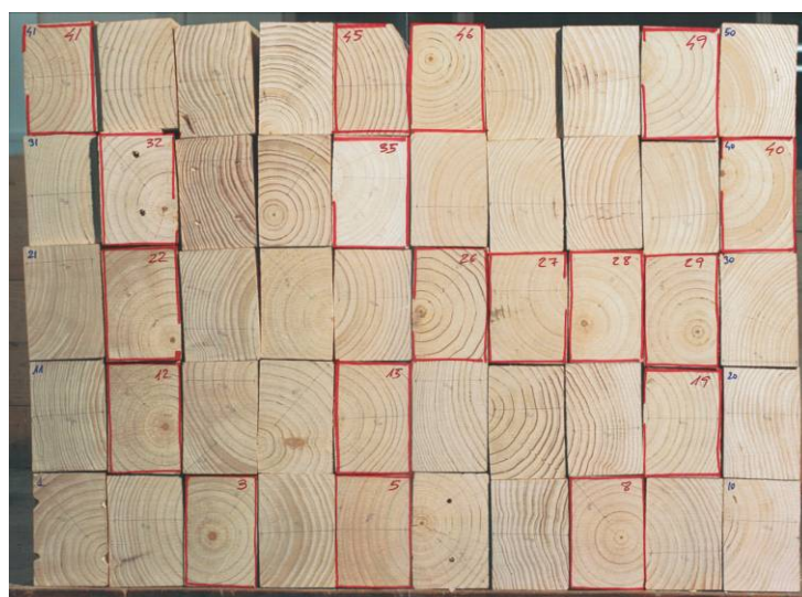
Figura 5.14 Cabezas de 50 probetas en las que se marcan en rojo las rechazadas.
