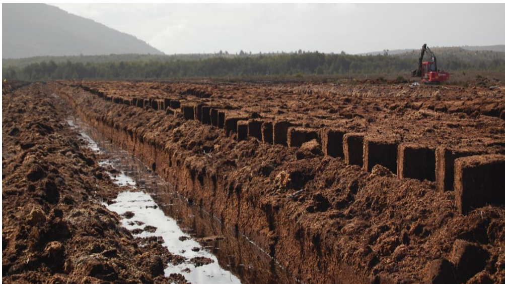
Fotografía N° 3.4. Extracción mecanizada de turba en bloques en Magallanes
