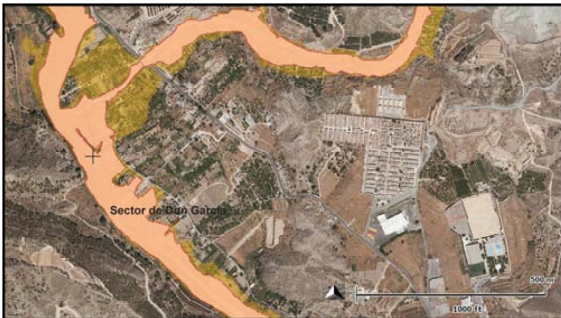
Figura 2.32: sectores inundables en el área comprendida entre el azud del Menjú y Las Canales. El color sin transparencia muestra las zonas inundables en un periodo de retorno de 50 años. El color con transparencia, las inundables en un periodo de retorno de 100 años.
