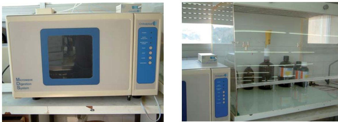
Figura 25. Microwave Digestión System O·I· Analytical y Cámara de Flujo laminar (Universidad Autónoma de Barcelona).
