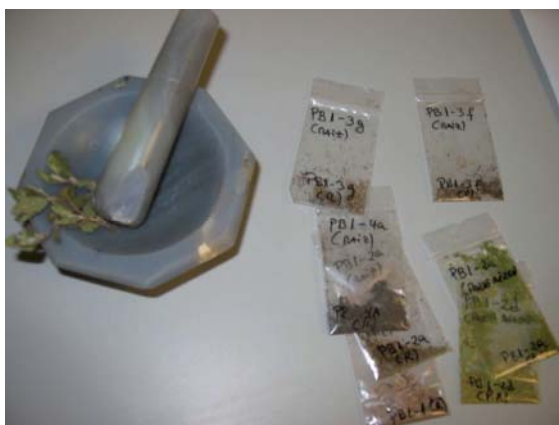
Figura 24. Triturado de las muestras de plantas
