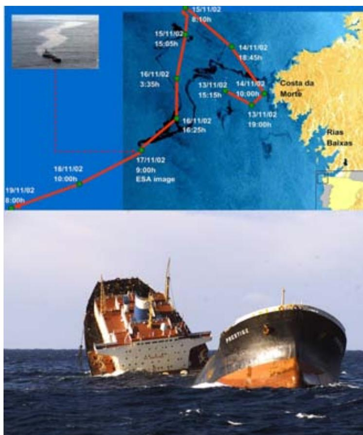
**Figura 8.** Imagen de satélite que muestra la mancha del fuel y el desplazamiento del petrolero *Prestige* averiado (arriba). El buque justo antes de su hundimiento (abajo).
